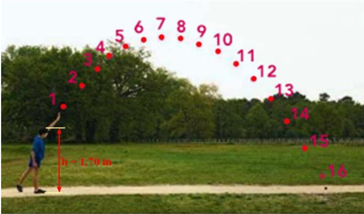
Un lycéen mesurant  $h = 1,70$  m effectue un lancer de « poids » de masse  $m = 4,0$  kg. On prendra la référence des énergies potentielles de pesanteur au niveau du sol. L'étude d'une vidéo de ce lancer a permis d'obtenir le relevé des positions ci-dessus. L'intervalle de temps entre deux positions consécutives vaut  $\tau = 80$  ms.
