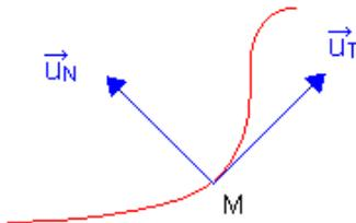
Lorsqu'un point M est animé d'un mouvement circulaire, on définit les coordonnées  $a_n$  et  $a_t$  du vecteur accélération  $\vec{a}$  selon deux directions :
