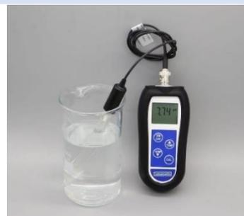
La tension  $U$  qui apparaît aux bornes de la sonde lorsqu'elle est plongée dans une solution aqueuse est une fonction affine du **pH**. Les grandeurs  $a$  et  $b$  sont des coefficients positifs qui dépendent de la température de la solution et de l'état des électrodes. Il est nécessaire d'étalonner le pH-mètre avant toute mesure à l'aide de deux solutions étalons de **pH** connu.
