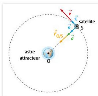
**Fig. 4** Accélération et vitesse sur une orbite circulaire.
