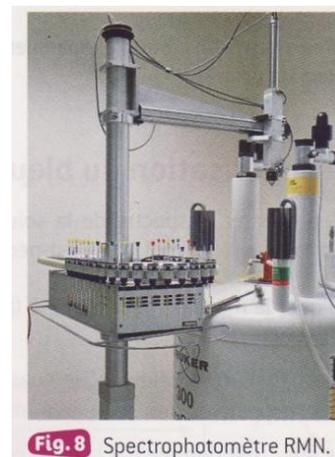
Fig. 8 Spectrophotomètre RMN.
